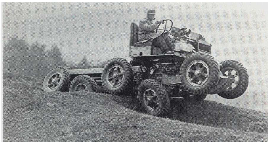
Die Aufnahme zeigt den Saurer 2M während einer Versuchsfahrt im Gelände. Sehr schön zu sehen, wie sich die einzelnen Räder dem Gelände anpassen.
