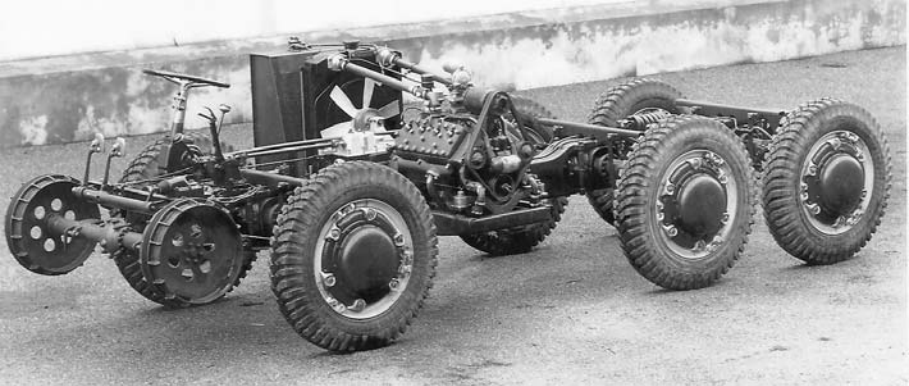
6ML-Chassis: Motor links, Kühler und Benzintank rechts am Zentralrohrrahmen. Die Auspuffrohre wurden unter dem Wasserkühler geführt.
