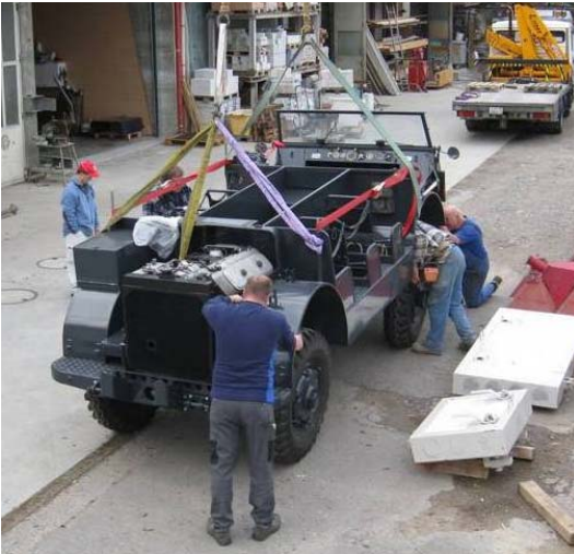
Aufsetzen Karosserie auf M+40014.
