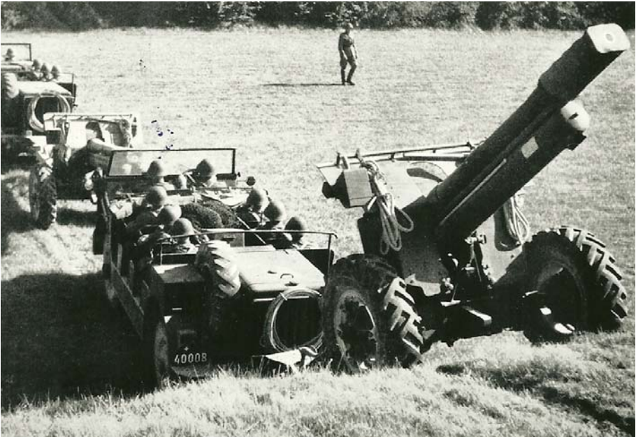
Geländefahrt mit Geschütz. Dank grossen Böschungswinkeln, grosser Bodenfreiheit und dennoch tiefem Schwerpunkt war der 4MH sehr geländetauglich.
