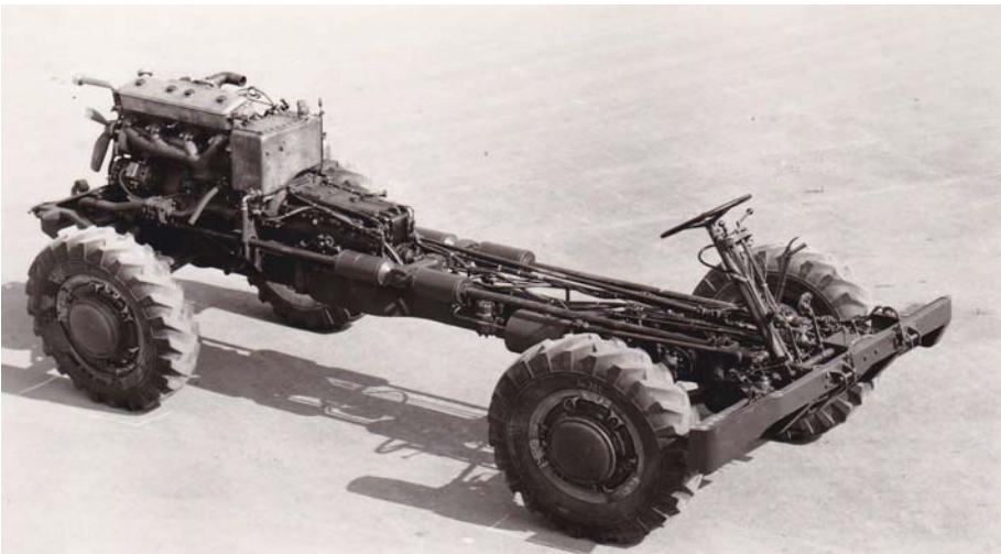
Das Chassis des Saurer 4ML mit Heckmotor.
